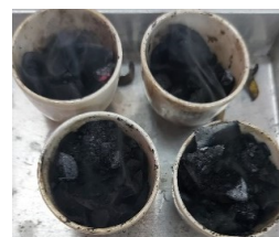
Gambar-1 : Kulit pisang jenis kepok sebelum dan setelah dikarbonisasi
