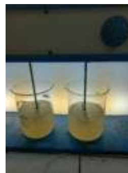
Gambar 1. Jar Test Pada Sistem Batch
