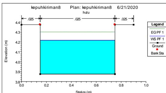
**Gambar-8:** Profil Penampang Saluran Kepuhkiriman 8 bagian Hulu
