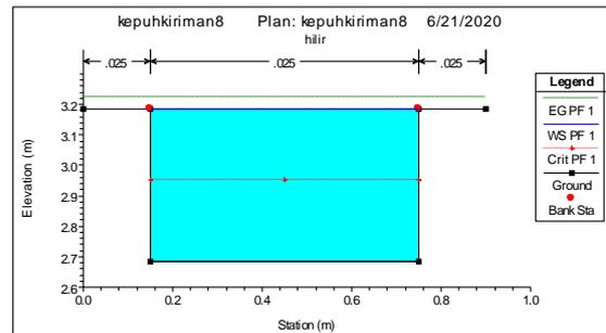
**Gambar-9:** Profil Penampang Saluran Kepuhkiriman 8 bagian Hilir
