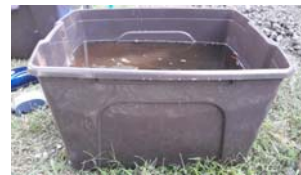
Gambar -8 : Bak Penampung/Pengendap Awal Skala Laboratorium
